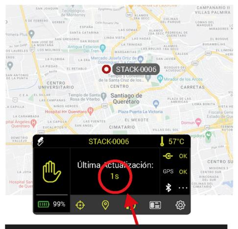
NOTA: La temperatura indicada en el stack corresponde exclusivamente a la del dispositivo, no refleja la temperatura ambiental de la unidad. Es importante tener en cuenta que esta temperatura puede incrementar durante el proceso de carga del equipo.
